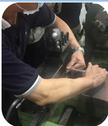
圖1-操作內六角扳手正確動作
